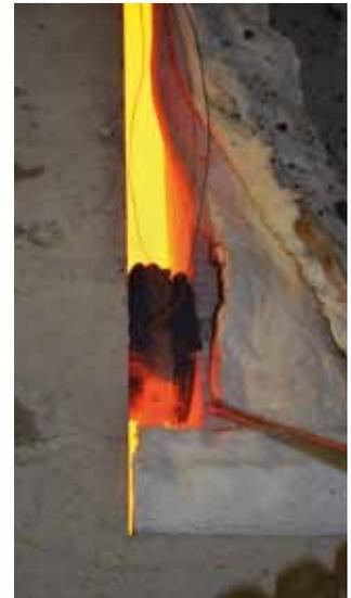
Bei Versuchen wurde eine Standzeit von über 120 Minuten ermittelt – damit erreichte Stacon Typ SLD die Feuerwiderstandsklasse R 120.
