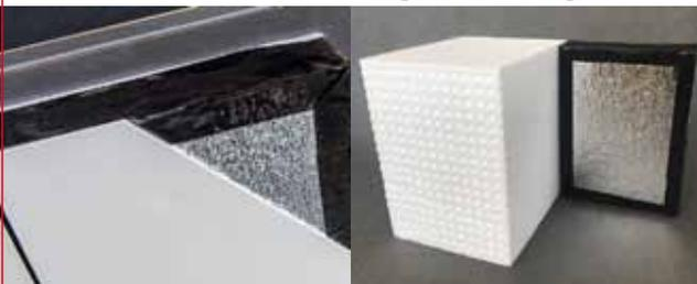
**1 cm Vakuumdämmung  $\approx$  5-8 cm Standard-Dämmstoff**
